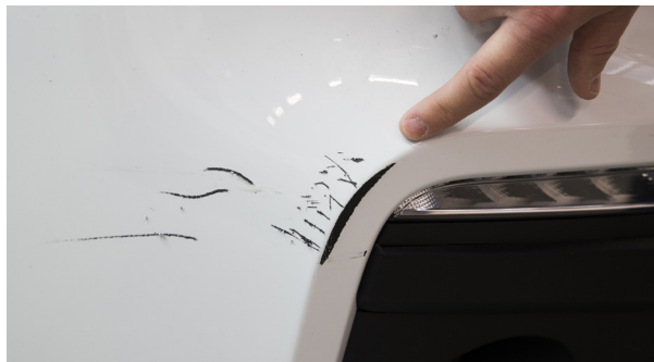
FØR: Skaden i støtfangeren er av den klassiske sorten, en slik du får når du feier inn i en vegg. Med Smart Repair tar den cirka to timer å utbedre, til 2750 kroner.
