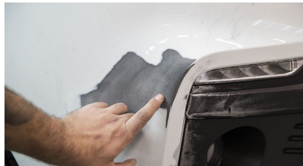
SPARKLET: Området på støtfanger slipes og et par steinsprutskader taes med i samme slengen, før området blir sparklet.
